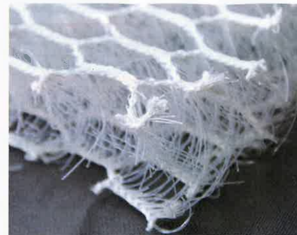
Les textiles 3D peuvent être utilisés dans les secteurs du transport (sièges) et des sports et loisirs (équipements). Composés d'un méta-aramide guipé d'un alliage métallique, ils servent notamment à la réalisation de structures de protection électromagnétique.
